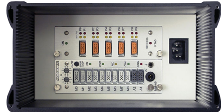
ALMEMO® 5790-2M09 IG2 Vue de dessous, fond ouvert (exemple : Circuit de mesure maître par carte relais ES5690RTA5)
