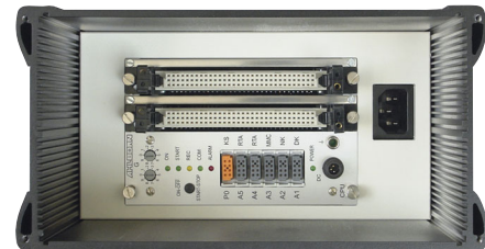
Système UC ALMEMO® 5790-2CPU IG2 Vue de dessous, fond ouvert (exemple : Carte UC (CPU) à 2 cartes de commutation (10 voies) EX5690MU)
