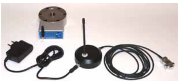
Figura a destra : connessioni durante la fase di ricarica della batteria
