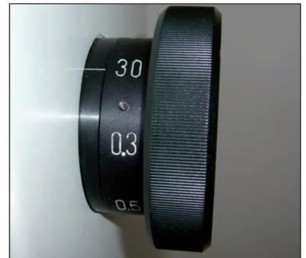
Sélection rapide des charges d'essai avec une indication numérique sur le panneau frontal et auto alignement de l'échelle de mesure correspondante
