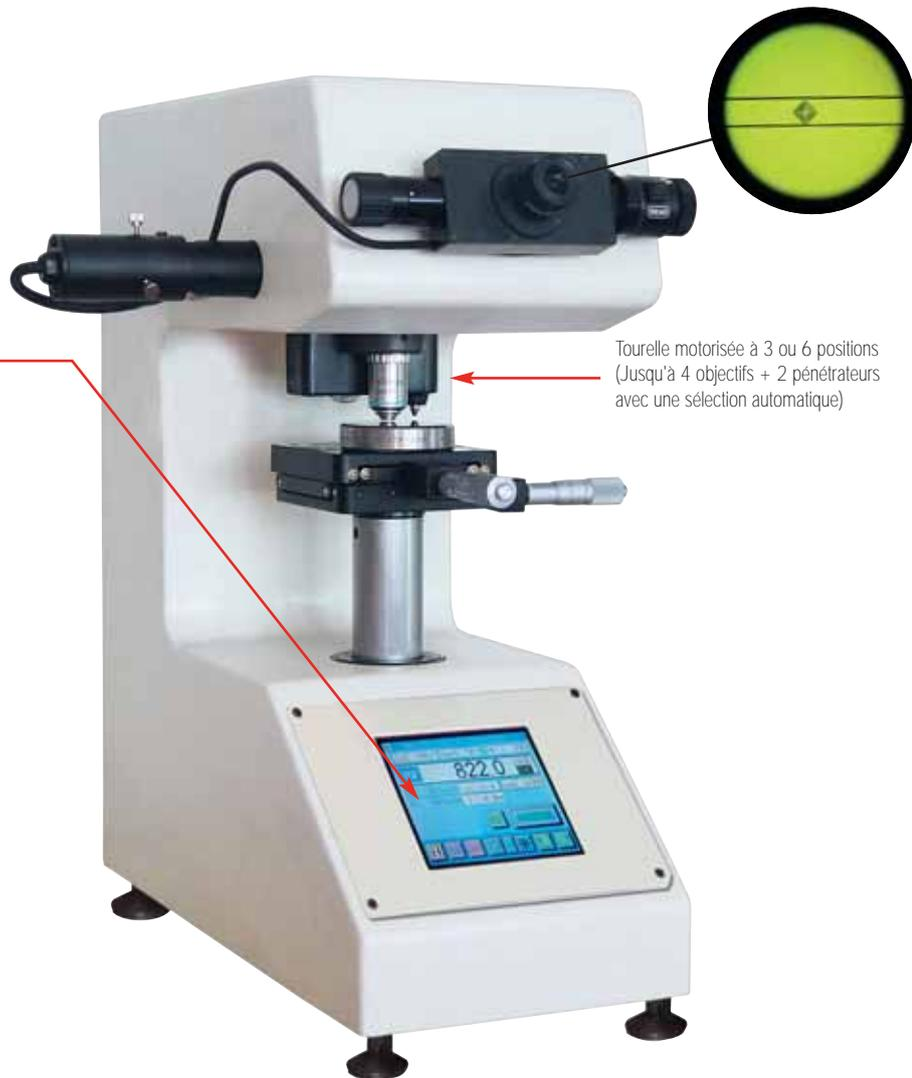
Tourelle motorisée à 3 ou 6 positions (Jusqu'à 4 objectifs + 2 pénétrateurs avec une sélection automatique)
