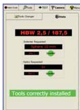
Indication d'insertion correcte du pénétrateur et objectif pour l'échelle choisie
