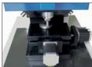
② Axes motorisés X Y Z pour des coupures et calcul profondeur dureté superficiel
