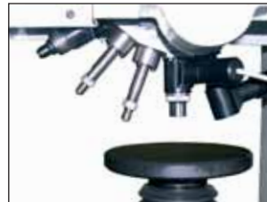
② Tourelle automatique sélection objectifs pénétrateur à 5 - 3 - 2 positions
