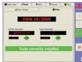
Indication de la correcte insertion pénétrateur et objectifs pour l'échelle sélectionnée
