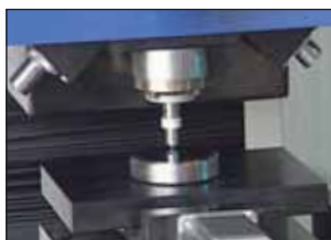
② Tourelle automatique selection objectifs pénétrateur à 5 - 3 - 2 positions
