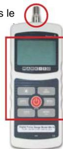
Le boîtier réversible permet au dynamomètre d'être tenu à la main ou monté sur le banc d'essai.
