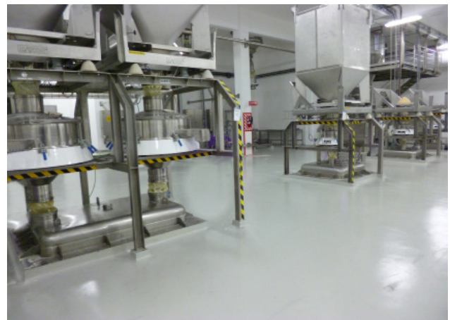
Figure 1 - Tamiseurs Russell Compact Sieve® installés dans une nouvelle usine de transformation de la poudre de lait au Chili
