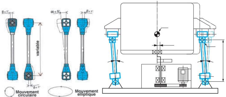
La liaison avec la structure du plafond se fait au moyen d'une tige filetée, ou à extrémités filetées (voir cote N), sauf pour le type AV 50, pour lequel la liaison se fait par 2 x 4 vis M 12 x 25.
