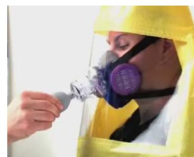
Réalisation d'un fit-test avec un 1/2 masque respiratoire X-plore®
