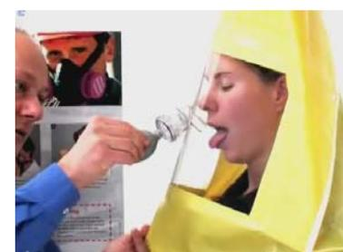
Réalisation d'un test de sensibilité préalable au fit-test Bitrex
