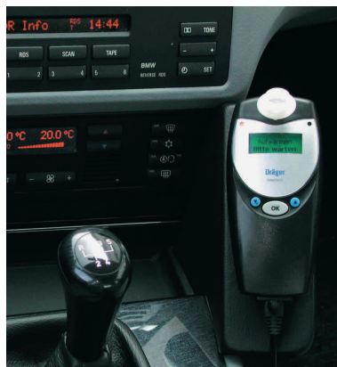
Dräger Interlock XT S'intègre au tableau de bord
