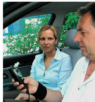
Dräger Interlock XT Utilisation dans une voiture particulière
