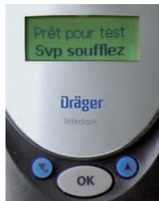
2. Stabilisation du capteur Message demandant de souffler dans l'Interlock XT Dräger
